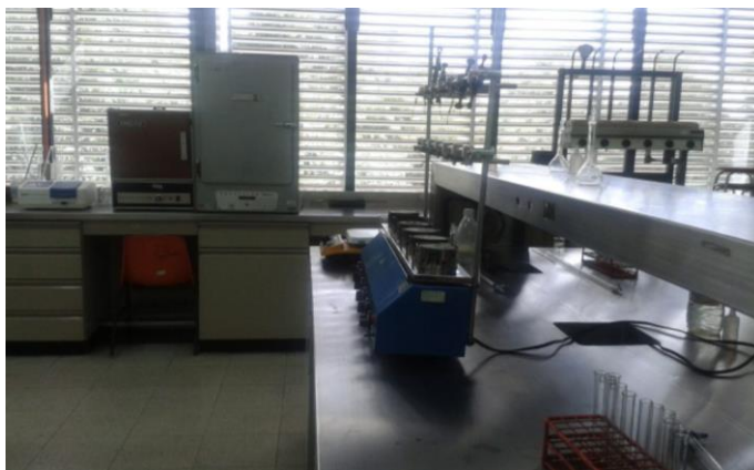
Equipo Soxhlet para digestiones con disolventes, y al fondo incubadoras para determinación de microbiológicos
