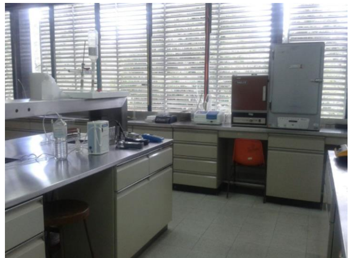
A la izquierda se encuentra el equipo de potabilización por ozono, un conductímetro y oxímetro. Al fondo dos incubadoras
