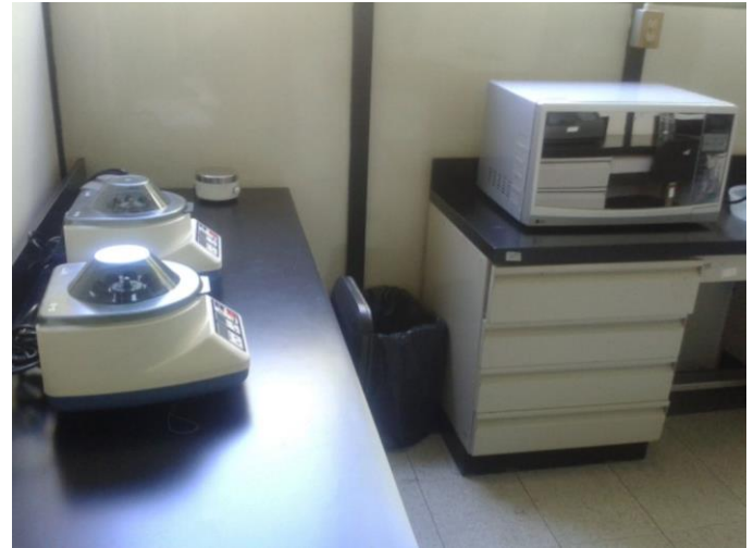
A la izquierda dos centrifugas de cabezal pequeño y al fondo un horno de microondas para realizar digestiones
