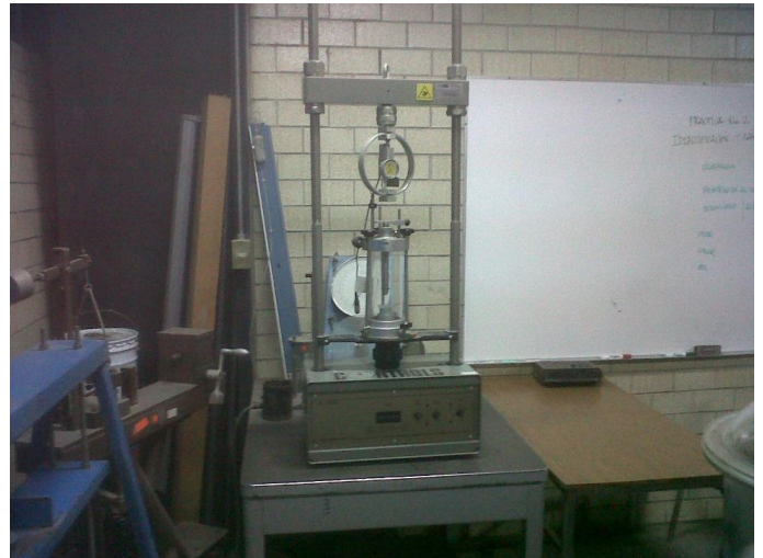
Cámara triaxial marca controls
