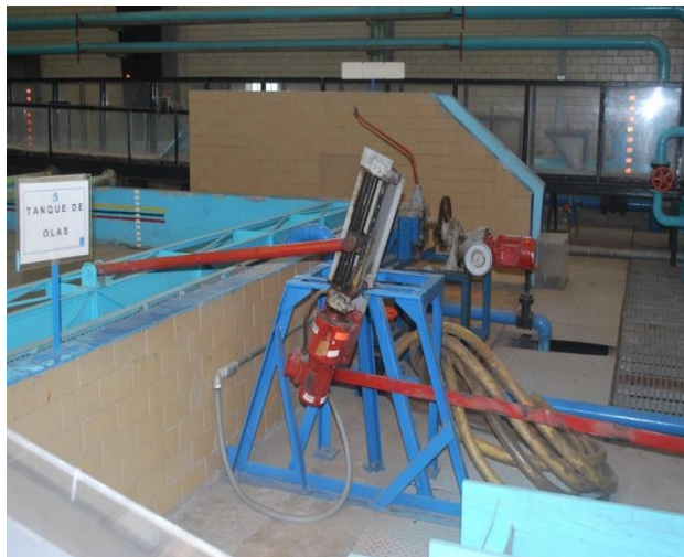
Tanque de olas para pruebas hidráulicas
