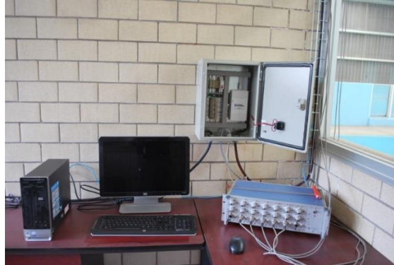
Sistema de control usando protocolo PLC a través de tarjeta de LabView
