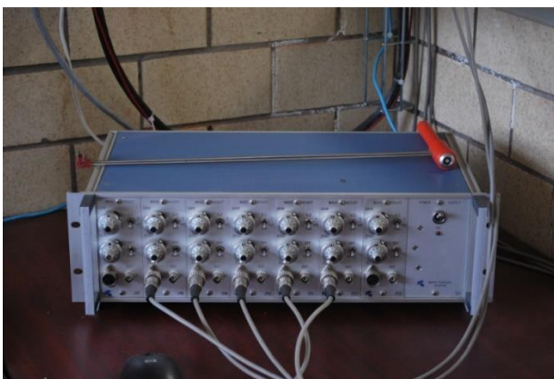
Amplificador de 8 canales y sensor de oleaje de tipo resistivo (DHI)
