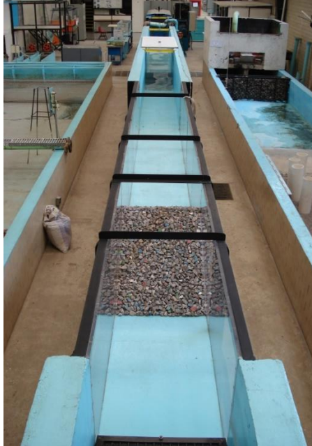
Canal de olas, con generador de olas marca HR Wallingford
