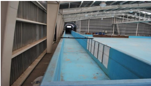
Tanque prismático, para arrastre de barcos y generación de corrientes
